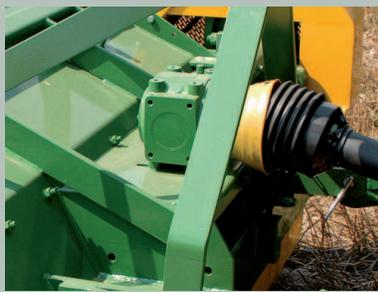
**Привод дробилки** сообщается от вала отбора мощности через кардан и подвижно закрепленной коробки передач, которая оборудована механизмом свободного хода; это воспрепятствует обратному переносу момента кручения ротора в трактор.
